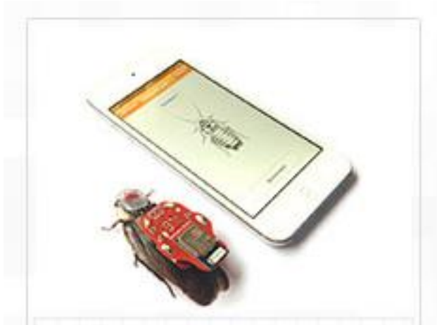
Figura 4. Acople BMI del Roboroach®
