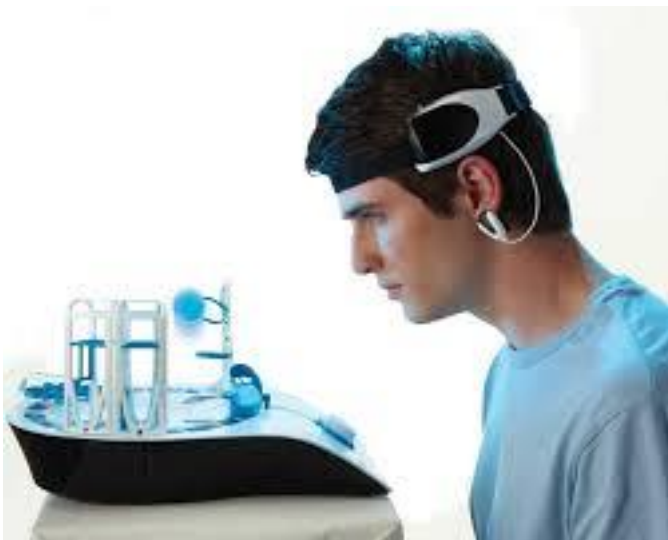
Figura 3. Diadema CD y consola DC del mindflex® acoplados
