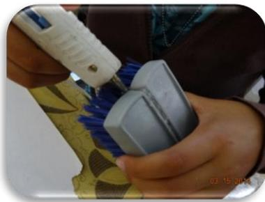
Figura 1.- Se observa cómo se unen con silicón los cepillos de plástico para lavar
