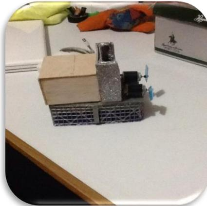
Funcionamiento: El funcionamiento del prototipo es con las baterías que mueven los dos motores y se con las hélices se logra un movimiento circular aspecto que se emplea mediante la cámara del celular que tiene integrada es posible transmitir el video en vivo de lo que está siendo grabado.
