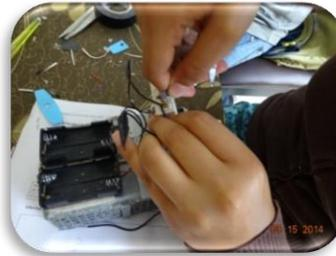
4. Montaje del porta pilas y motores a las bases de los cepillos.
